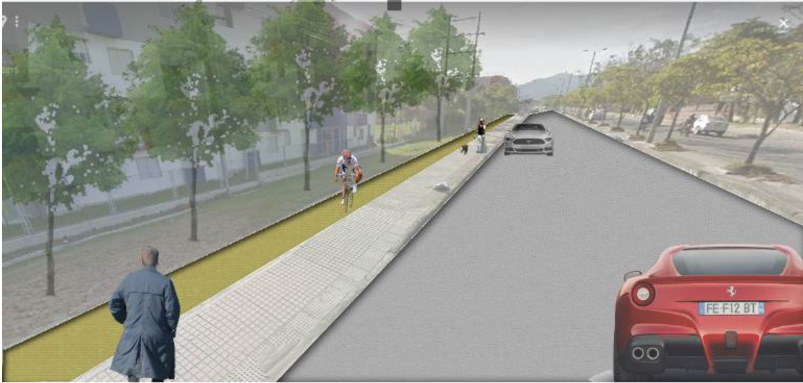
Figura 15. Propuesta- tramo de ciclorruta de andén compartido.
